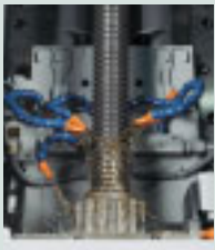
■写真1 photo1 従来加工 Conventional 塩素分を多量に含有する 油性クーラントを大量に使用
