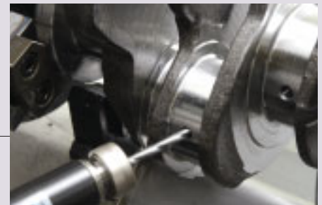
クランクシャフトへの穴あけ加工 MQL machining of a crankshaft
