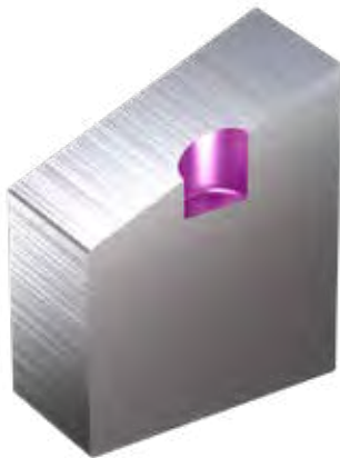
Guide Drilling 导向孔
